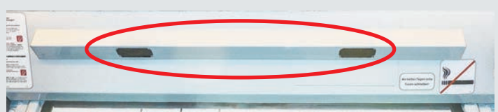
Mit solchen Infrarotsensoren über den Türen werden in Bussen und U-Bahnen Fahrgastzahlen ermittelt.
